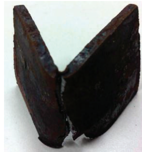
(ข) ชิ้นทดสอบที่ผ่านการทดสอบการรับแรงกระแทก
