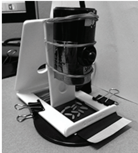
รูปที่ 2 การยึดตัวกล้องเพื่อถ่ายภาพในงานวิจัย
