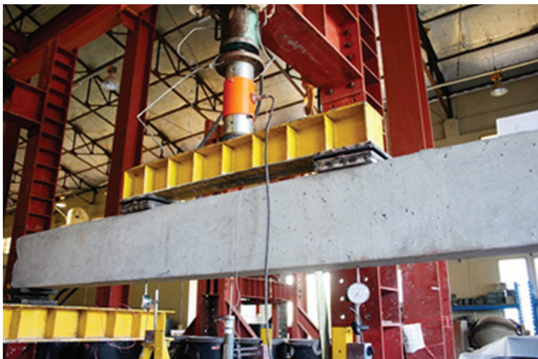
รูปที่ 3 การติดตั้งตัวอย่างทดสอบ (มหาวิทยาลัยเทคโนโลยีสุรนารี)
