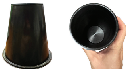
รูปที่ 9 ผลการฉีดขึ้นงานแก้วกาแฟที่มีระบบช่องระบายอากาศ
