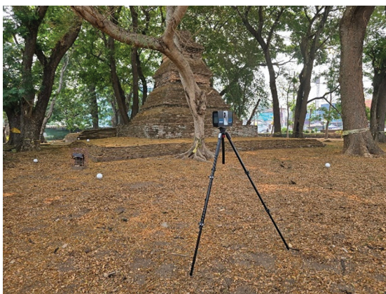
รูปที่ 6 การสแกนภาคสนามด้วยเครื่องสแกน Faro Focus M70
