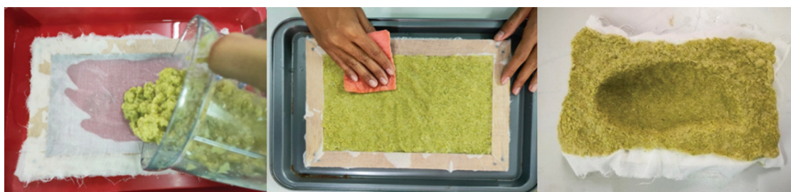
รูปที่ 3 การขึ้นรูปบรรจุภัณฑ์ผลไม้จากกากหน่อไม้ฝรั่งและเส้นใยใบอ้อย
