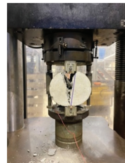
(จ) ทดสอบกำลังดึงคอนกรีต
