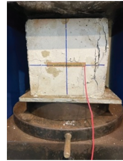
(ค) ทดสอบกำลังอัดคอนกรีต
