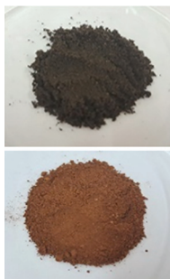
(ก) ผงสีดินดำและดินแดง (ข) ผงดินผสมแป้งพิมพ์สำเร็จรูป รูปที่ 1 การผสมสีหมึกพิมพ์กรีน
