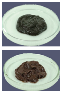
(ก) ผงสีดินดำและดินแดง (ข) ผงดินผสมแป้งพิมพ์สำเร็จรูป รูปที่ 1 การผสมสีหมึกพิมพ์กรีน
