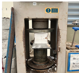
(ข) ทดสอบแรงอัด
