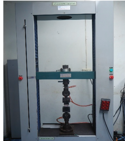
(ข) เครื่องทดสอบแรงดึงแรงอัด ขนาด 40 kN ทดสอบแรงดึงดึงฉากผิวหน้า
