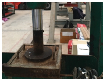
(จ) กดขึ้นรูปด้วยแรง 25 Ton แล้วนำไปบ่มในอากาศ
