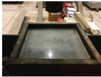
(ข) ทาน้ำมันที่แบบหล่อ แล้ววางแผ่นอะคริลิก
