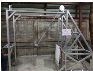
(ก) ชุดเครื่องมือทดสอบ เพนดูลัมเทส (ข) ขนาดตัวอย่าง ผนังอิฐก่อ (ค) การเตรียมตัวอย่าง ผนังอิฐก่อเสริมกำลังด้วยไม้ไผ่ รูปที่ 3 ชุดเครื่องมือทดสอบเพนดูลัมเทสและการเตรียมตัวอย่างผนังอิฐก่อในงานวิจัย
