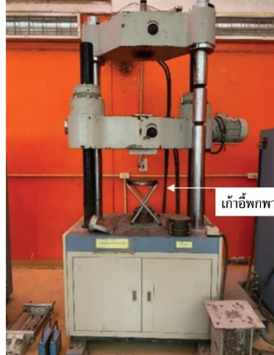
รูปที่ 3 การทดสอบการรองรับน้ำหนักของผ้าทอบนเก้าอี้พกพา
