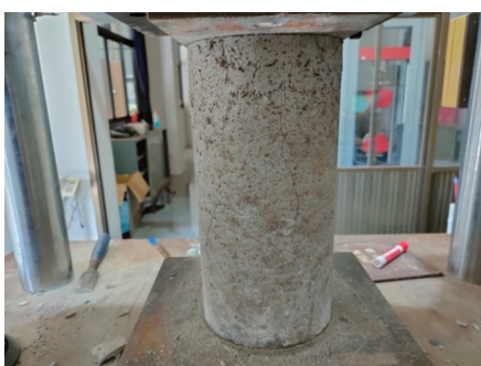
(ก) การทดสอบกำลังรับแรงอัด
