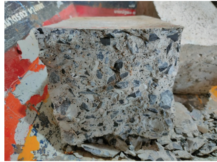
(ก) การติดตั้งตัวอย่างทดสอบแรงอัด (ข) หน้าตัดตัวอย่างทดสอบหลังเกิดการวิบัติ รูปที่ 3 การทดสอบแรงอัดของคอนกรีตผสมเศษยางรถยนต์
