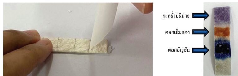
รูปที่ 2 ขั้นตอนการสร้างกระดาษบ่งชี้อินดิเคเตอร์จากเส้นใยชานอ้อยที่มีสารสกัดแอนโทไซยานิน
