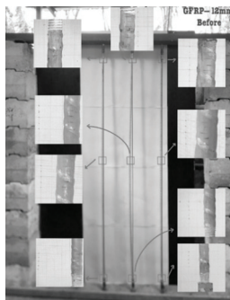
(ก) วัสดุ GFRP ขนาด 12 มิลลิเมตร ก่อนดึง (ข) วัสดุ GFRP ขนาด 12 มิลลิเมตร หลังดึง รูปที่ 12 การเปรียบเทียบพฤติกรรมก่อนและหลังให้แรงดึงขนาด 30 ปอนด์ ในวัสดุ GFRP ขนาด 12 มิลลิเมตร
