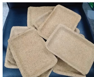
รูปที่ 2 ตัวอย่างโฟมชีวภาพต้นแบบจากเส้นใยจากกล้วยและแป้งมันสำปะหลัง (พันธุ์ 81) ที่เคลือบด้วยไขฝั ง
