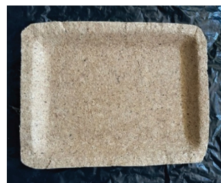
รูปที่ 2 ตัวอย่างโฟมชีวภาพต้นแบบจากเส้นใยจากกล้วยและแป้งมันสำปะหลัง (พันธุ์ 81) ที่เคลือบด้วยไขฝั ง
