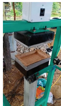
รูปที่ 1 การอัดขึ้นรูปด้วยความร้อนของการผลิตโฟมชีวภาพจากเส้นใยจากกล้วยและแป้งมันสำปะหลัง (พันธุ์ 81)
