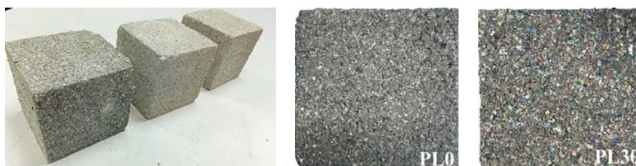
รูปที่ 3 ก้อนตัวอย่างคอนกรีตระบบอัด
