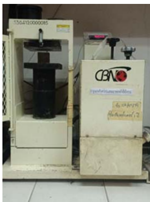
รูปที่ 4 เครื่องทดสอบกำลังรับแรงอัดของตัวอย่างจีโอโพลิเมอร์มอร์ตาร์
