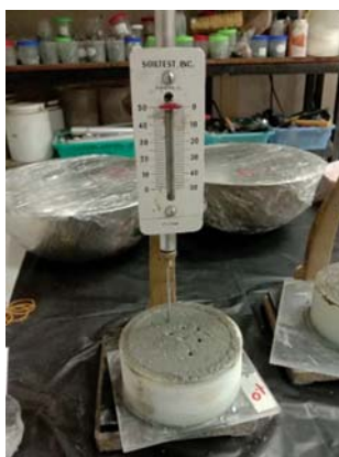
รูปที่ 2 การทดสอบระยะเวลาการก่อตัวของจีโอโพลิเมอร์มอร์ตาร์
