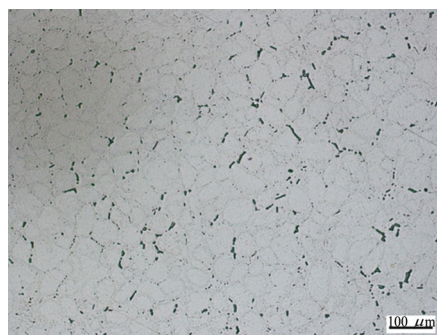
(ก) ครึ่งที่หนึ่งที่อุณหภูมิ 110 °C เวลา 8 ชั่วโมง (ข) ครึ่งที่สองที่อุณหภูมิ 170 °C เวลา 1 ชั่วโมง รูปที่ 7 โครงสร้างจุลภาคของชิ้นงานที่ผ่านการบ่มแข็งครึ่งที่หนึ่ง และครึ่งที่สอง
