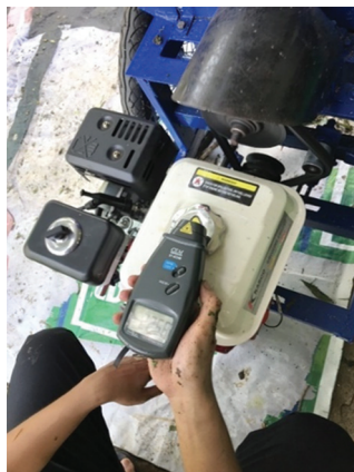
รูปที่ 6 ความเร็วรอบใบมีดเครื่องสับย่อยที่วัดด้วยเครื่องวัดความเร็วรอบแบบแสง
