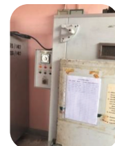
อบแห้งด้วยความร้อน 80 องศาเซลเซียส 5 ชั่วโมง แล้วนำมาร่อนผ่านตะแกรง 100 เมช
