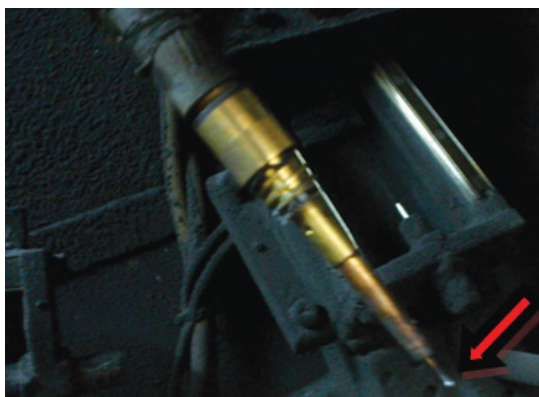
รูปที่ 5 แสดงสะเก็ดของงานเชื่อมที่ติดอยู่กับหัวทังสเตน
