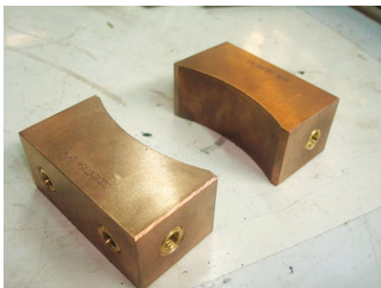
รูปที่ 10 แปลงถ่านที่นำมาเปลี่ยนเข้ากับเครื่อง Cap Side Welding
