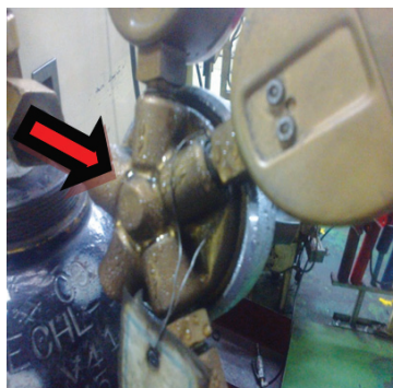
รูปที่ 6 ใอน้ำที่เกาะบริเวณรอบอุปกรณ์วัดความดัน
