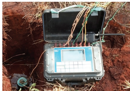
(ก) เครื่องปล่อยกระแสไฟฟ้า Zonge GTT-10 (ข) เครื่องวัดค่าความต้านทานไฟฟ้า Scintrex IPR-12
