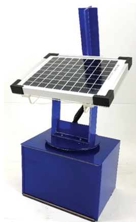
รูปที่ 8 โมดูลระบบติดตามดวงอาทิตย์แบบสองแนวแกนประยุกต์ใช้ร่วมกับแผงเซลล์แสงอาทิตย์
