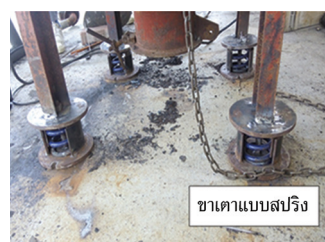
รูปที่ 3 การติดตั้งชุดสร้างแรงสั่นสะเทือน (ก) ชุดสร้างแรงสั่นสะเทือน (ข) การติดตั้งชุดสร้างแรงสั่นสะเทือน (ค) ติดตั้งขาเตาแบบสปริง
