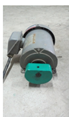
รูปที่ 3 การติดตั้งชุดสร้างแรงสั่นสะเทือน (ก) ชุดสร้างแรงสั่นสะเทือน (ข) การติดตั้งชุดสร้างแรงสั่นสะเทือน (ค) ติดตั้งขาเตาแบบสปริง
