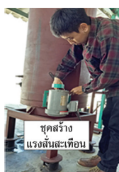
รูปที่ 3 การติดตั้งชุดสร้างแรงสั่นสะเทือน (ก) ชุดสร้างแรงสั่นสะเทือน (ข) การติดตั้งชุดสร้างแรงสั่นสะเทือน (ค) ติดตั้งขาเตาแบบสปริง
