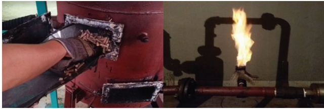
รูปที่ 6 การจุดเตาแก๊สซิฟิเคชันเพื่อเริ่มต้นผลิตแก๊สและการจุดทดสอบว่าแก๊สติดไฟหรือไม่
