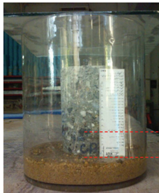
รูปที่ 10 การทดสอบการยกตัวของน้ำเนื่องจากแรงดึงดูดผิวน้ำในคอนกรีต (CTB)
