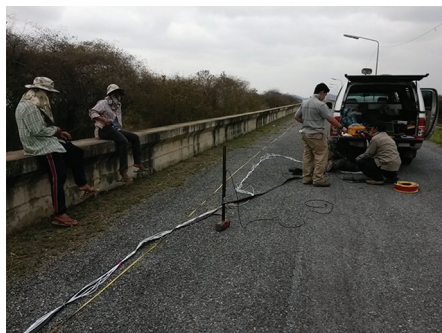
รูปที่ 6 การเชื่อมต่อสัญญาณบันทึกผลกับชุดสาย Land Streamer
