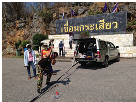
รูปที่ 7 การกำเนิดคลื่นสั่นสะเทือนด้วยการทุบหมอน น้ำหนัก 20 ปอนด์
