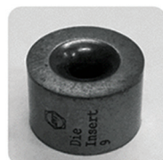
Die angle ( 2\alpha ) = 18^\circ
