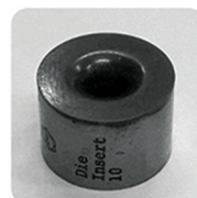
Die angle ( 2\alpha ) = 20^\circ
