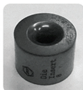
Die angle ( 2\alpha ) = 16^\circ
