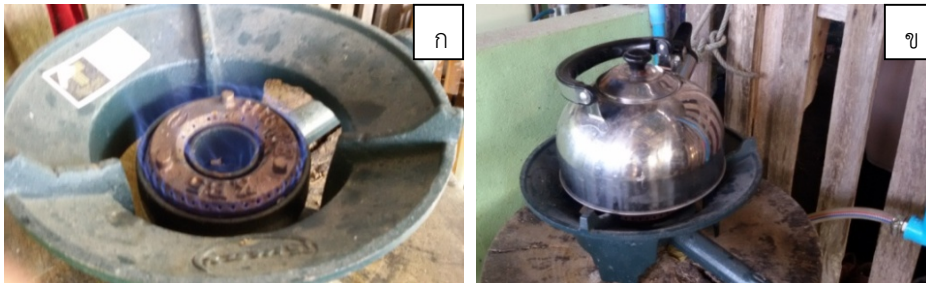
ภาพที่ 2 ทดสอบการใช้งานการติดไฟจากการหมักแก๊สชีวภาพที่ได้จากบ่อหมัก ก) ลักษณะของเปลวไฟ ข) การใช้งานของแก๊สชีวภาพที่ได้จากบ่อหมัก
