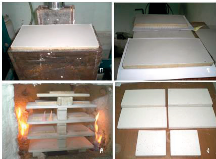
ภาพที่ 2 กระบวนการขึ้นรูปแผ่นรองเผาคอร์เตียไรต์ด้วยแบบพิมพ์โลหะ (ก) การขึ้นรูปแผ่นรองเผาให้แห้ง (ข) การเผาแผ่นรองเผาคอร์เตียไรต์ (ค) แผ่นรองเผาคอร์เตียไรต์ที่ผ่านการเผาแล้ว (ง)
