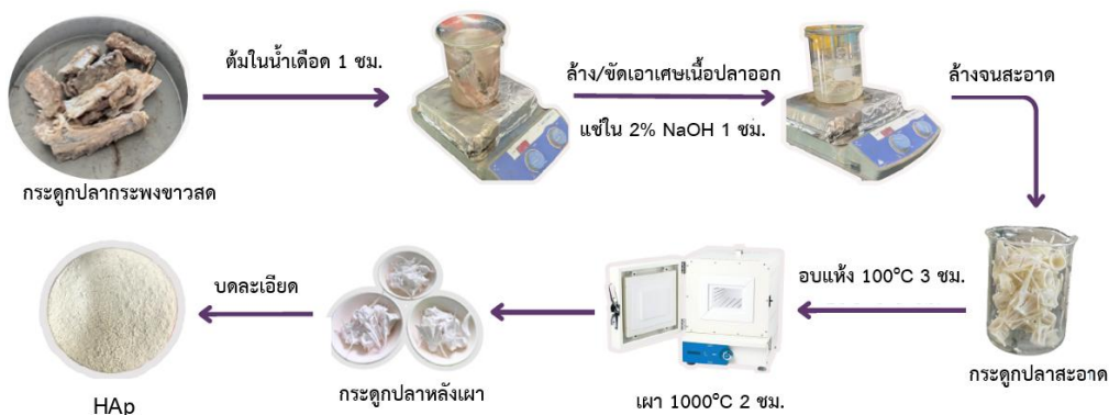
ภาพที่ 1 ขั้นตอนการสังเคราะห์ไฮดรอกซีอะพาไทต์ (HAp) จากชีวมวลกระดูกปลากะพงขาว
