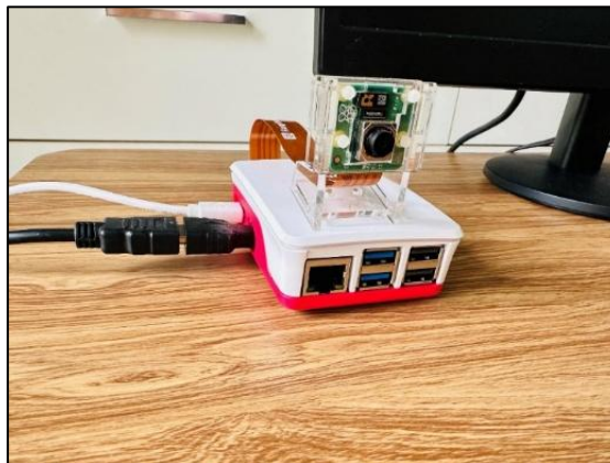
ภาพที่ 4 เชื่อมต่อกับ Camera Module 3 กับ Raspberry Pi 5
