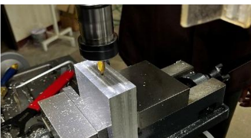
รูปที่ 7 การเจาะเพื่อสร้างรูไหลของแม่พิมพ์
