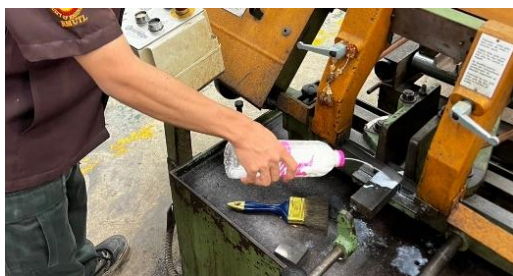
รูปที่ 5 การเตรียมเหล็กกล้าคาร์บอน S50C ตามขนาดที่ออกแบบ
