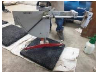
รูปที่ 9 การทดสอบค่าความต้านทานการลื่นไถลด้วยเครื่องมือ BPT ก่อนการจำลองสภาพการใช้งาน
