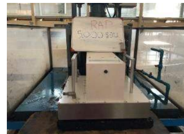
รูปที่ 11 การทดสอบค่าความต้านทานการลื่นไถลด้วยเครื่องมือ DFT ภายหลังการจำลองสภาพการใช้งาน
