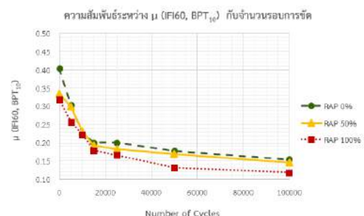
รูปที่ 18 กราฟแสดงความสัมพันธ์ระหว่าง \mu (IFI60, BPT 10 ) กับจำนวนรอบการขัด
