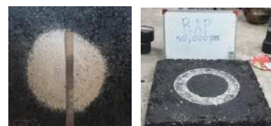
รูปที่ 8 การทดสอบ MTD ด้วยวิธี Sand Patch Method (SPM)
