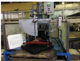
รูปที่ 10 การทดสอบค่าความต้านทานการลื่นไถลด้วยเครื่องมือ BPT ภายหลังการจำลองสภาพการใช้งาน
