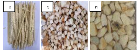
รูปที่ 2 รูปร่างโฟมพียูที่ใช้ทำไส้กรองอากาศ (ก) แบบเส้น (ข) แบบลูกเต๋า และ (ค) แบบก้อน
