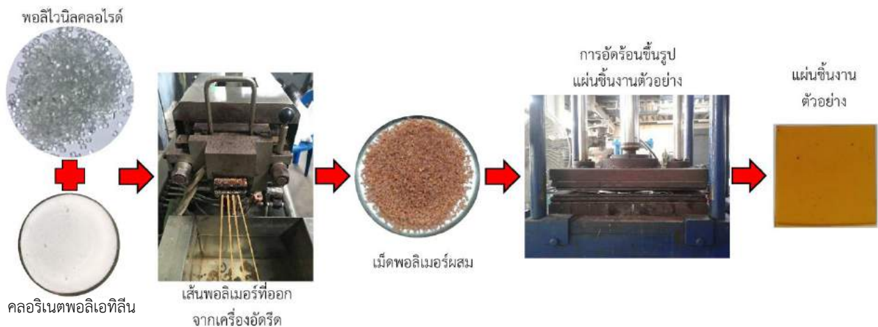
รูปที่ 2 กรรมวิธีการขึ้นรูปแผ่นขึ้นงานตัวอย่างจากพอลิเมอร์ผสมระหว่างพอลิไวนิลคลอไรด์และคลอรีนเทฟลอนที่ลิ้น
