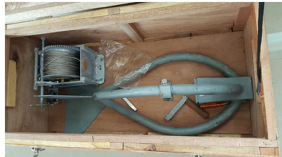
รูปที่ 2 เครื่องมือเก็บตะกอนท้องน้ำ แบบ Helley-Smith Sediment Samples Bed Load Model BL-87
