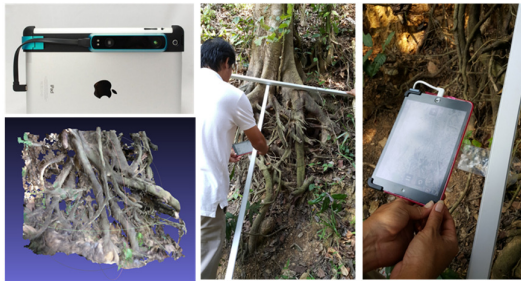
รูปที่ 11 เก็บรายละเอียดรากโดยวิธีสแกน แบบ 3 มิติ
