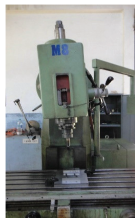
รูปที่ 3 การเอียงหัวพินในขั้นตอนการเชื่อม
