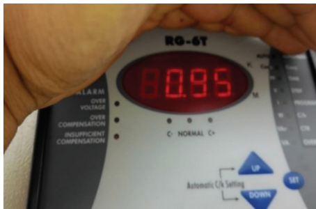
รูปที่ 8 อุปกรณ์ควบคุมค่าตัวประกอบกำลังทำงานได้อย่างปกติ
