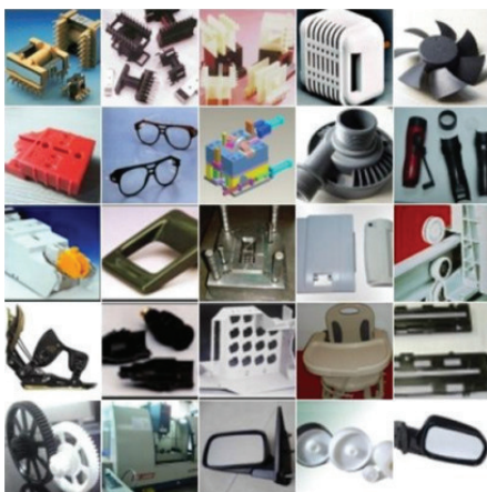
รูปที่ 2 ชิ้นงานที่ได้จากการฉีดขึ้นรูป [2]
