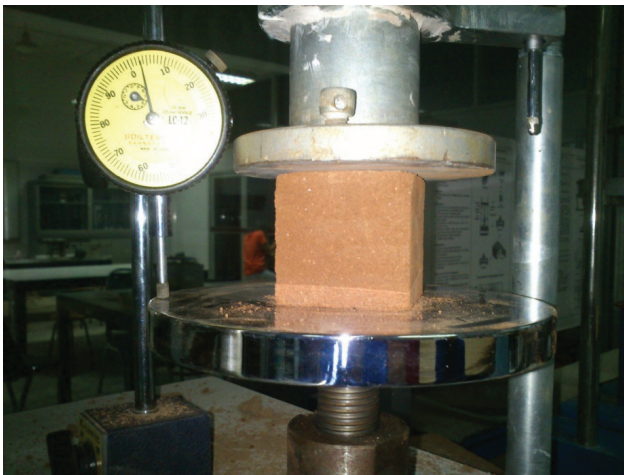
รูปที่ 3 การทดสอบกำลังรับแรงอัดของตัวอย่างตามมาตรฐาน ASTM C109
