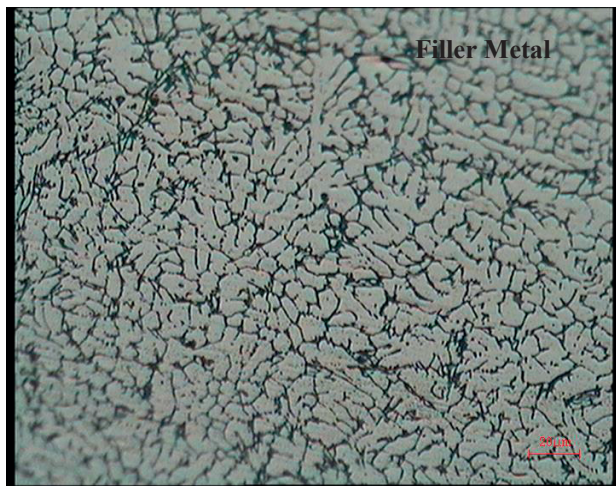
รูปที่ 4 โครงสร้างจุลภาคบริเวณโลหะเติม
