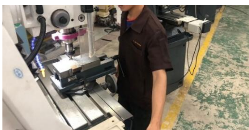
รูปที่ 6 การสร้างโครงแม่พิมพ์ด้วยเครื่องกัด
