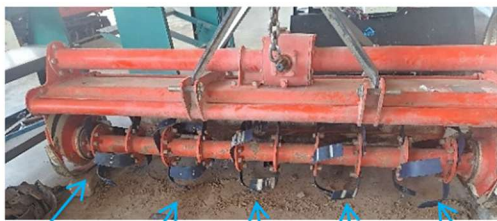
แบบตุ้ม ด้านหน้าและด้านหลังใบมีด แบบตุ้ม ด้านหน้าใบมีด แบบลิ้ม ด้านหน้าและด้านหลังใบมีด แบบลิ้ม ด้านหน้าใบมีด แบบใบมีดผสมที่มีใช้โดยทั่วไป รูปที่ 4 เครื่องพรวนจอบหมุนที่ทำการติดตั้งใบมีด 5 รูปแบบ
