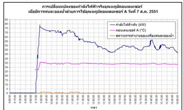
รูปที่ 18 ข้อมูลการทำงานของระบบพ่นละอองน้ำด้วยการใช้อุณหภูมิจาก อุณหภูมิคอนเดนเซอร์ A ในวันที่อากาศเย็นและมีฝนตกบ่อยๆ
