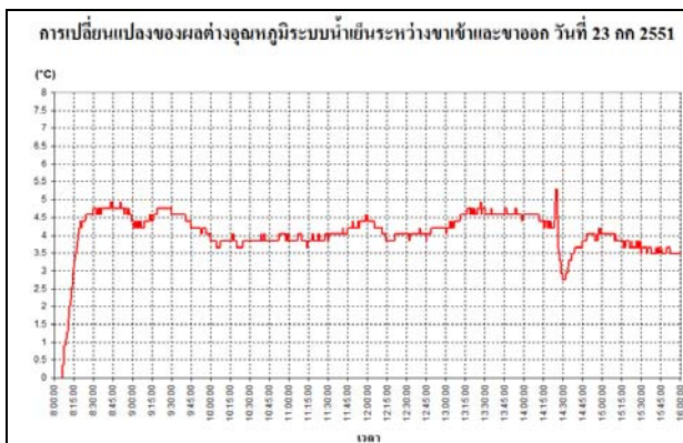
รูปที่ 6 การเปลี่ยนแปลงของค่าผลต่างอุณหภูมิระบบน้ำเย็นระหว่างขาเข้าและขาออก
