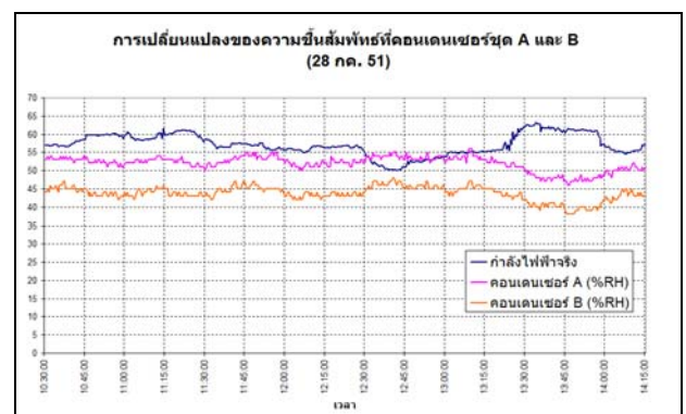
รูปที่ 16 เปรียบเทียบการเปลี่ยนแปลงความชื้นสัมพัทธ์บริเวณคอนเดนเซอร์ ระหว่างด้านที่มีการพ่นละอองน้ำกับด้านที่ไม่ถูกพ่น
