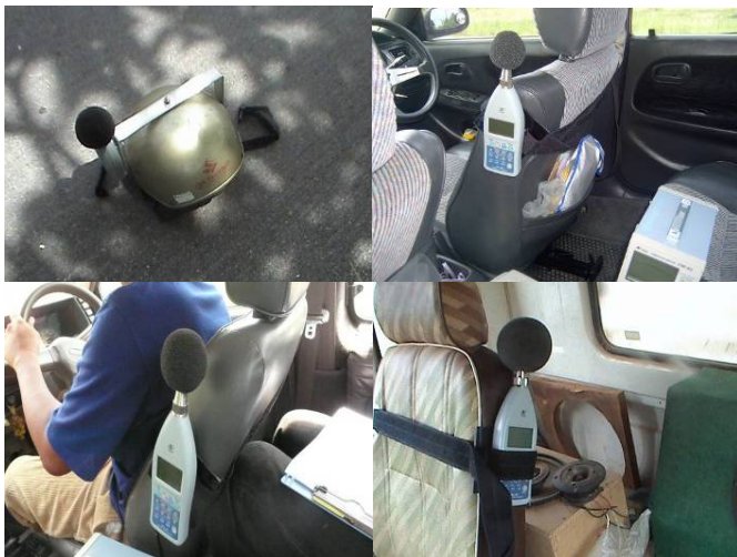
รูปที่ 15 การติดตั้งเครื่องมือวัดระดับเสียงภายในห้องโดยสาร
