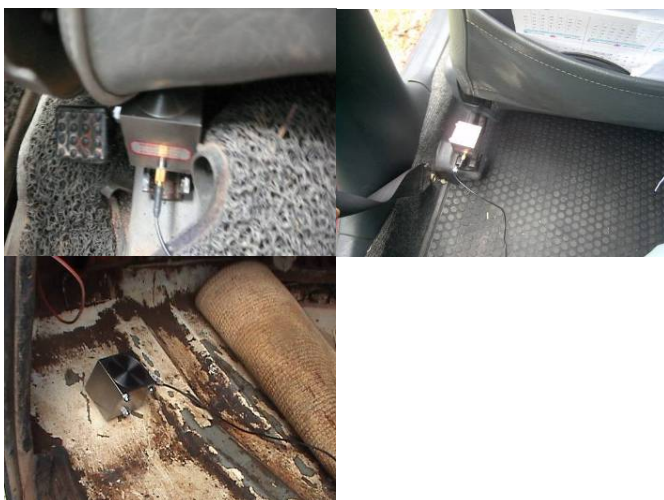
รูปที่ 16 การติดตั้งเครื่องมือวัดการสั่นสะเทือนภายในห้องโดยสาร
