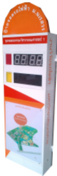
รูปที่ 8 ต้นแบบป้ายแสดงเวลาของรถไฟฟ้า
