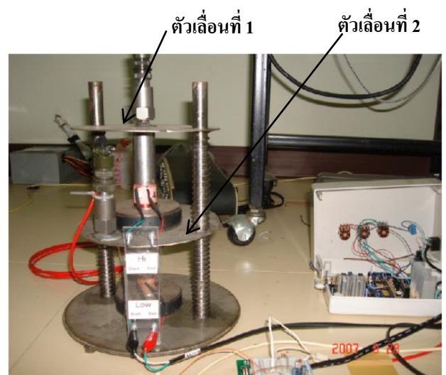
รูปที่ 5 ชุดทดลองตัวดูดซับการสั่นสะเทือนแบบปรับค่าได้
