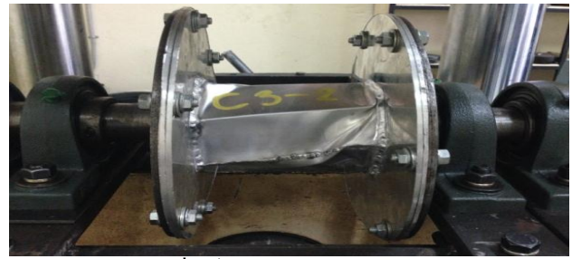
รูปที่ 6 ชิ้นงานกำลังเสียรูปเนื่องจากการบิด
