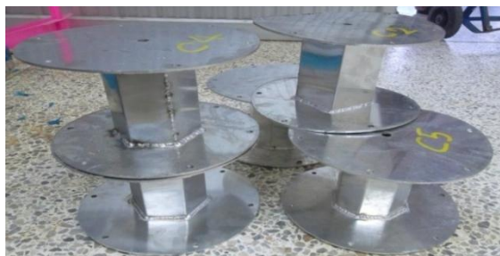
รูปที่ 5 ชิ้นงานต่อกับแผ่นวงกลมเชื่อมติดทั้งสองด้าน
