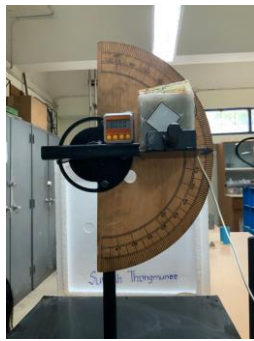
รูปที่ 13b การทดสอบเพื่ออ่านค่าการทำงานของ gyro sensor
