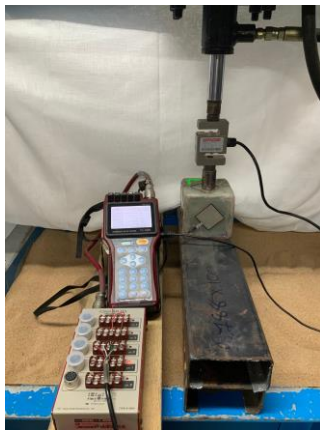
รูปที่ 11b การทดสอบเพื่อประเมินค่าความเค้นที่กระทำต่อผิวนอกของ Prototype เมื่อมีแรงกระทำ
