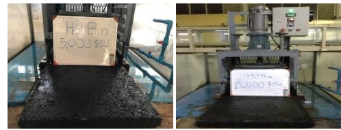
รูปที่ 7 การทดสอบการขัดสีด้วยเครื่อง TWPD
